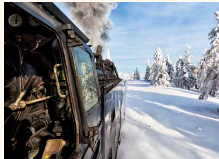
Die Sicht des Lokführers einer Dampflokomotive ist durch deren Kessel eingeschränkt, weshalb die Streckenbeobachtung auch dem Heizer auf der linken Seite obliegt. Der Schein der tief stehenden Wintersonne erhellte am 30. Januar 2012 den Führerstand von 99 7240 auf dem Weg zum Brocken. Foto: Olaf Haensch
