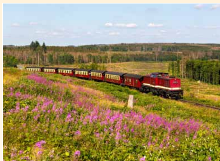
Die lange Zeit vorwiegend für Güterzug- und Rangierdienste verwendeten Diesellokomotiven der Baureihe 199.8 – ursprünglich für Regelspur gebaute V 100 der Deutschen Reichsbahn – kommen seit einiger Zeit auch planmäßig vor Personenzügen zum Einsatz, so 199 861 am 18. Juli 2021. Foto: Dirk Bahnsen
