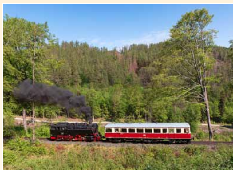
Eine Rarität war diese Situation am 11. Mai 2022: 99 222 schob den seit 2015 in Aufarbeitung befindlichen Triebwagen 187 012 im Thumkuhental bergan. Der Grund für die Fahrt war eine Erprobung der Laufeigenschaften der beiden neu gebauten Drehgestelle. Foto: Dirk Bahnsen
