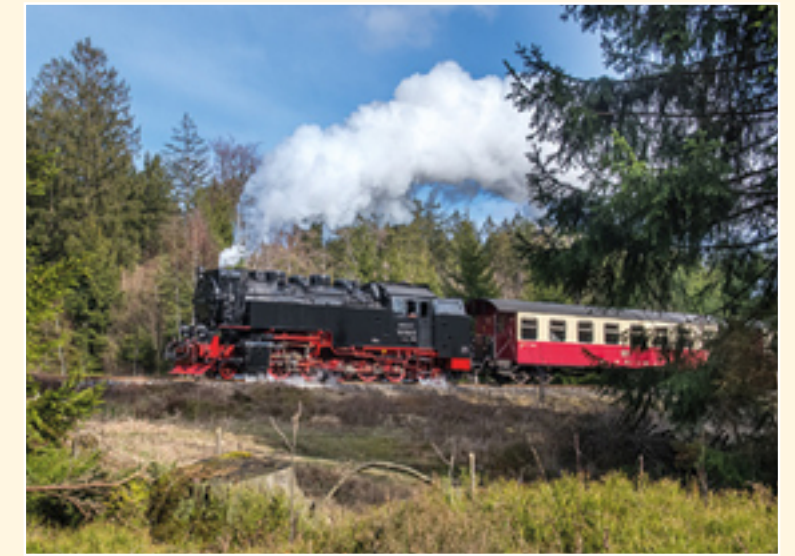
Am 14. März 2020 war der 1956 gebaute 99 7243 der N 8904 von Eisfelder Talmühle nach Drei Annen Hohne anvertraut. 2011 erfolgte im Dampflokwerk Meiningen eine umfassende Rekonstruktion, bei welcher die Maschine einen neuen Rahmen und neue Dampfzylinder erhielt. Foto: Klaus-Henning Damm
